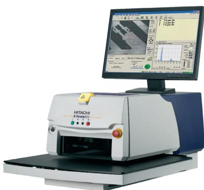
Толщиномер X-STRATA 920 — это рентгено-флюоресцентная система с возможностью микрофокусировки для неразрушающего контроля, быстрых анализов примесных материалов, измерения толщин многослойных покрытий и элементного состава в широком спектре материалов, измеряемые элементы от Ti22 до U92.
